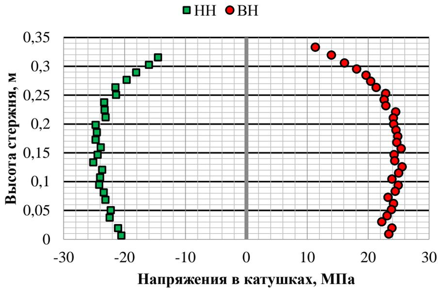
Рисунок 6 – Механические напряжения, действующие на катушки и витки
