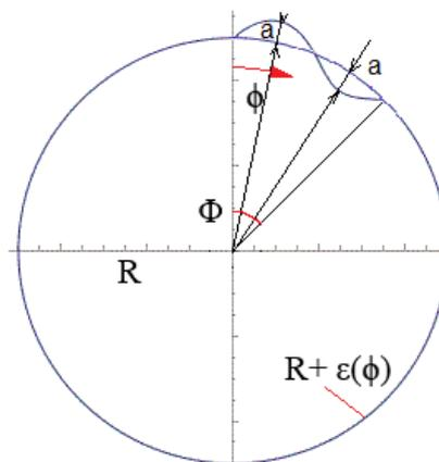
Рисунок 1 – Геометрическая интерпретация деформации витка обмотки
