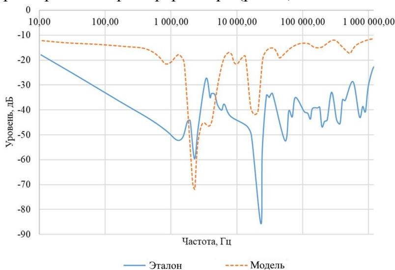
Рисунок 8 – Расчетная (пунктирная) и экспериментальная (сплошная) частотная характеристика обмотки НН.
