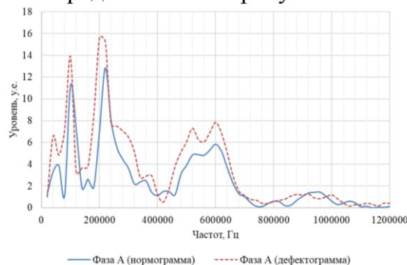
Рисунок 10 - Частотная характеристика фазы «А» по схеме *a-b*.
