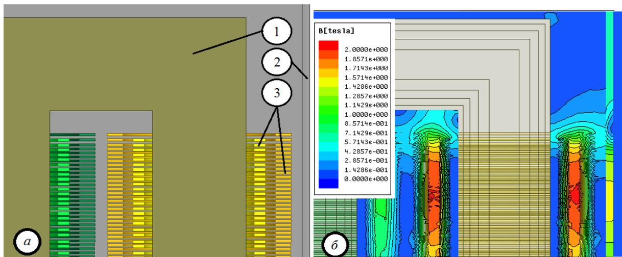
Рисунок 5 – Геометрическая модель трансформатора (а): (1) – магнитопровод; (2) – бак; (3) – обмотки трансформатора. Картина магнитного поля в режиме короткого замыкания (б)
