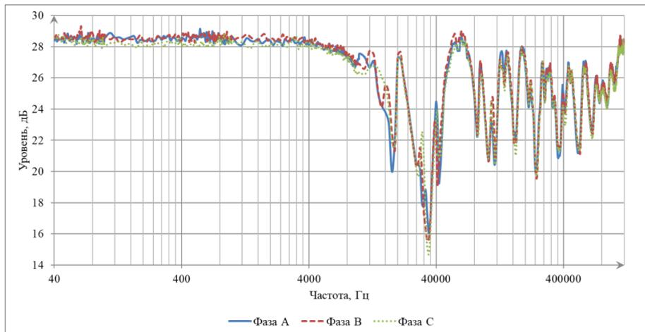
Рисунок 9 - Частотные характеристики силового трансформатора 5 МВА
