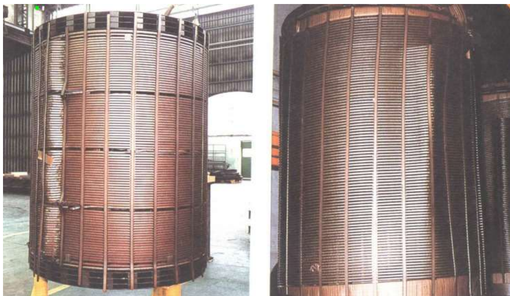
Рисунок 1.5 - Пример потери радиальной устойчивости (свободное изгибание)
