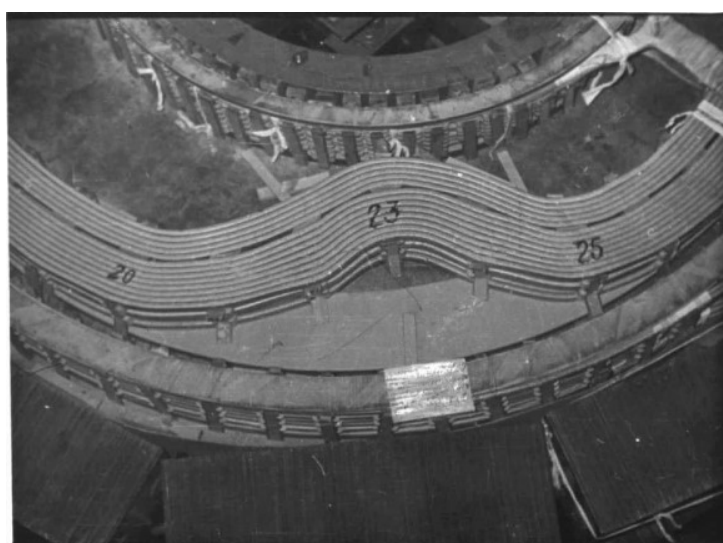
Рисунок 1.4 - Пример потери радиальной устойчивости (свободное изгибание)
