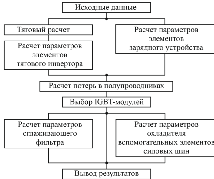
Рисунок 2 – Структурная схема методики расчета компонентов ТИЗУ
