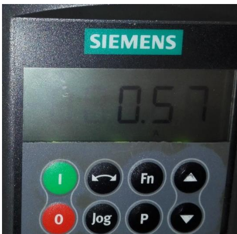
Рисунок 4.24 – Ток статора I_1
