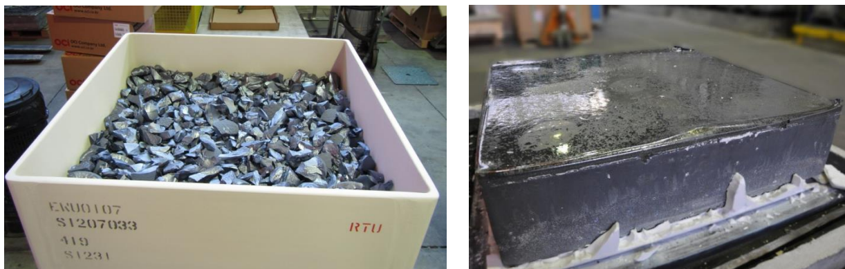
Рис.1.2 Кремний перед и после плавления
