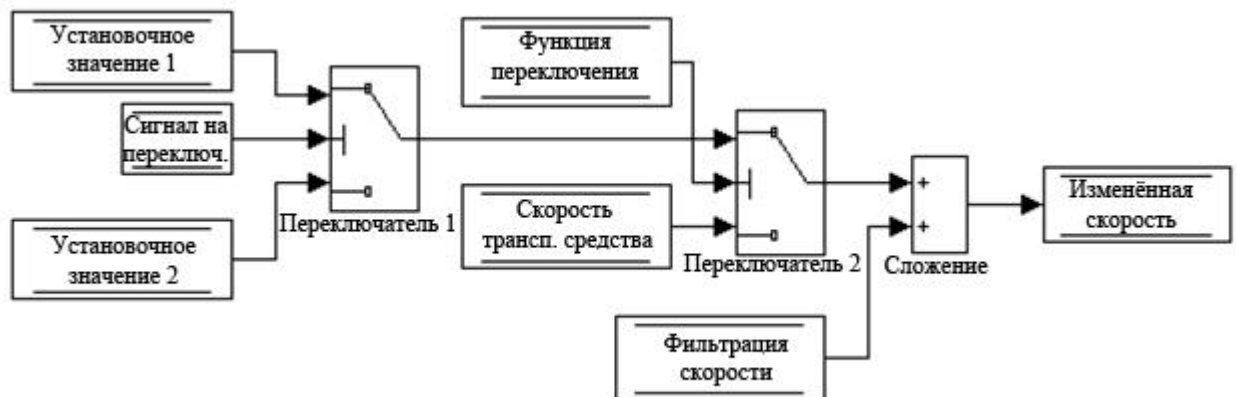
Рисунок 4.10 – Расчет рассогласования скорости и уставки
