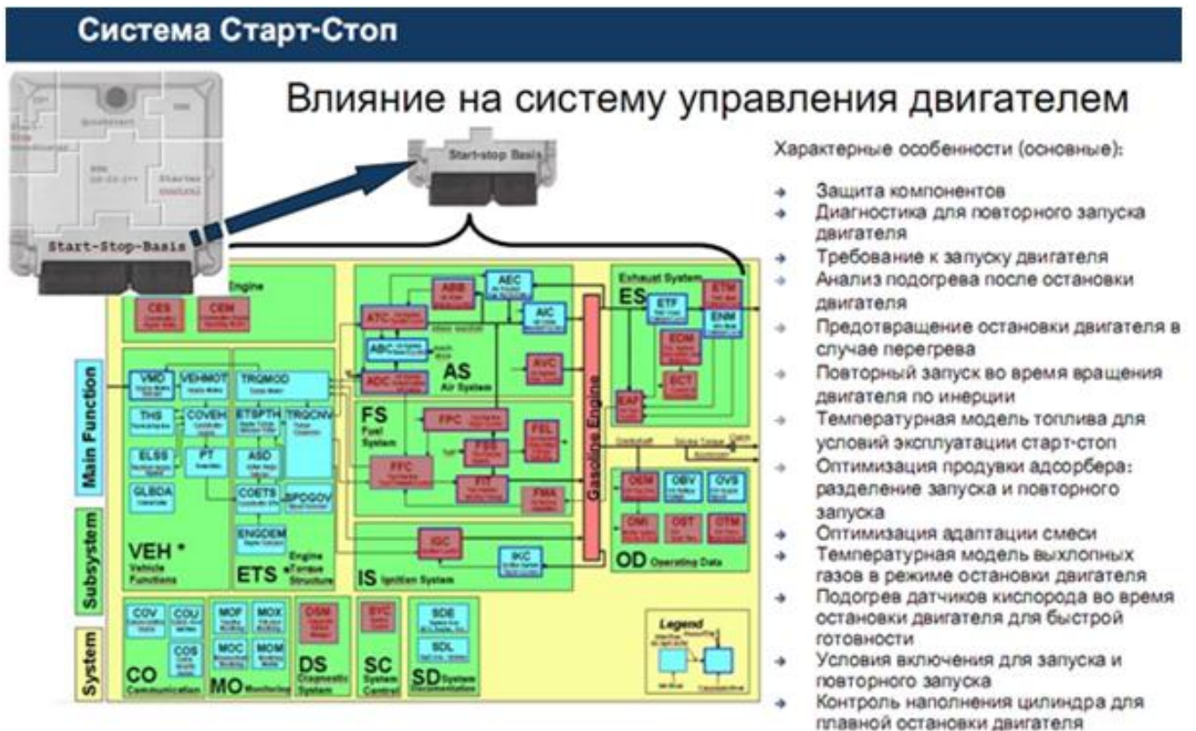
Рисунок 4.29 – Функции системы «Старт – Стоп» влияющие на работу ЭСУД
