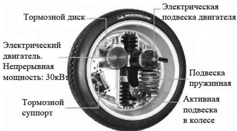
Рисунок 1.17 – Конструкция мотор-колеса совместной разработки Peugeot и Michelin
