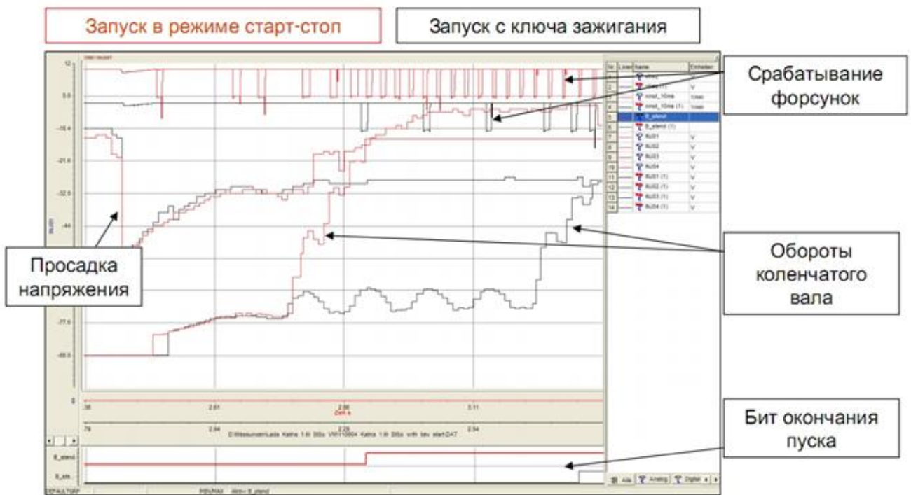
Рисунок 4.31 – Диаграммы реализации режима «быстрый пуск» для автомобиля с системой «Старт – Стоп» и без нее
