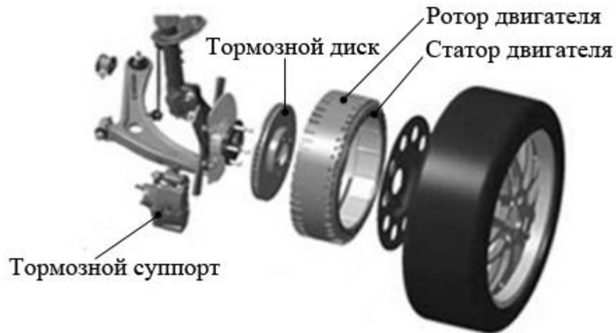
Рисунок 1.16 – Конструкция электропривода колес Mitsubishi
