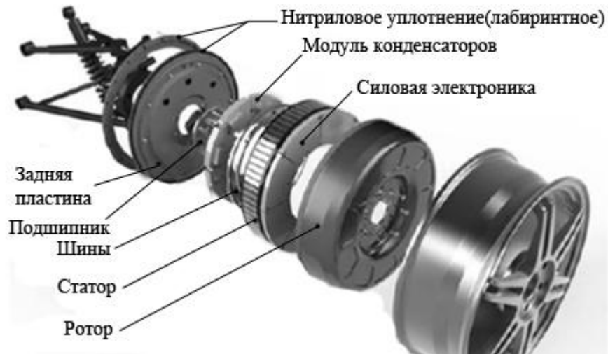
Рисунок 1.19 – Конструкция мотор-колесо фирмы Protean
