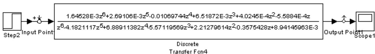
Рисунок 3.5 – Расчетная модель четырехконтурного следящего электропривода с асинхронным двигателем 1LA7083-2AA10-Z в виде дискретной передаточной функции
