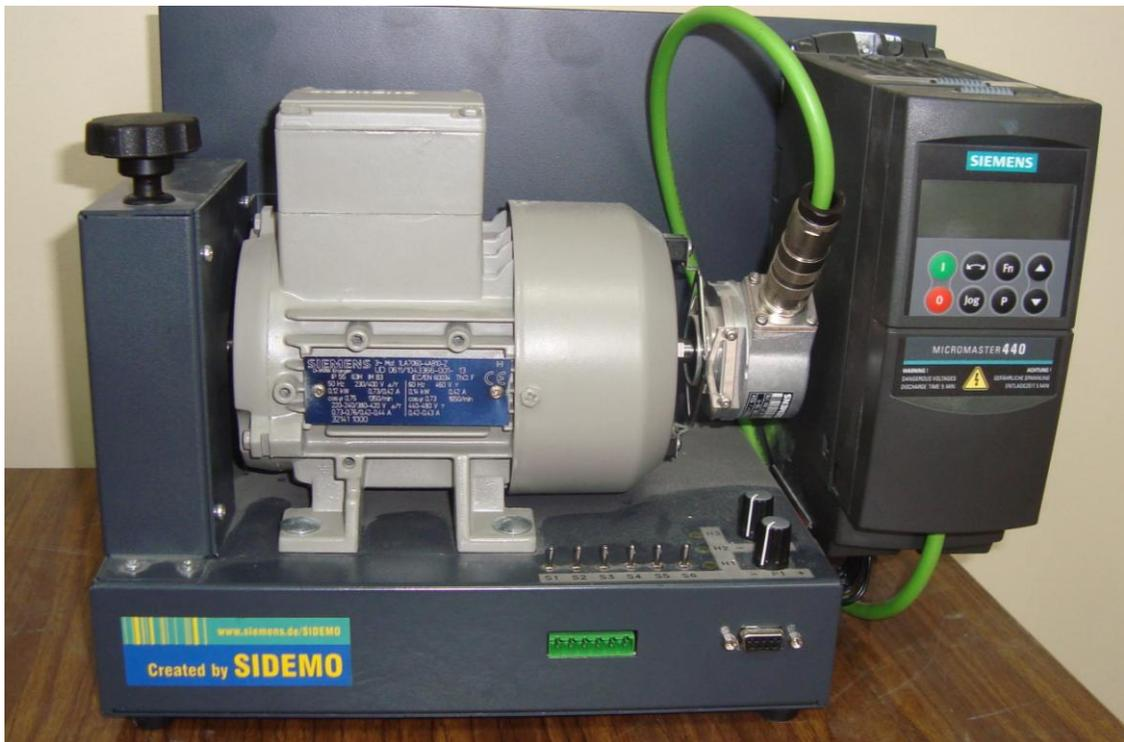
Рисунок 4.1 – Экспериментальная установка на базе демонстрационного стенда Sidemo с частотным преобразователем Micromaster 440
