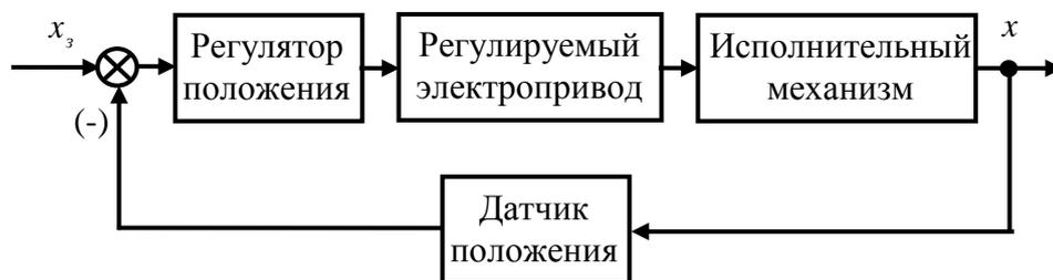
Рисунок 1.4 – Функциональная схема следящего электропривода
