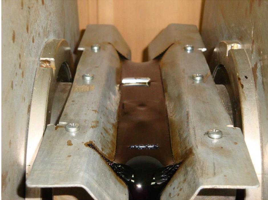
Рисунок 4.12. Фотография расположения алюминиевой частиц в зазоре сепаратора, выталкиваемой на поверхность магнитной жидкости при токе  $I=1,4$  А
