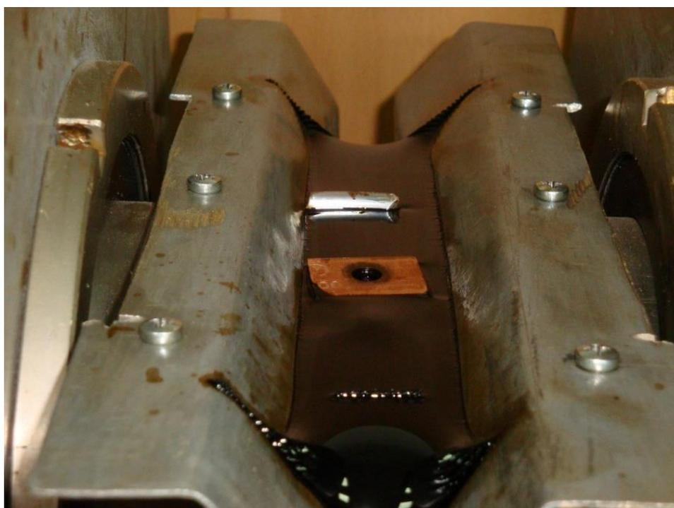
Рисунок 4.11. Фотография расположения медной и алюминиевой частиц в зазоре сепаратора, выталкиваемых на поверхность магнитной жидкости при токе  $I=1.6 A$
