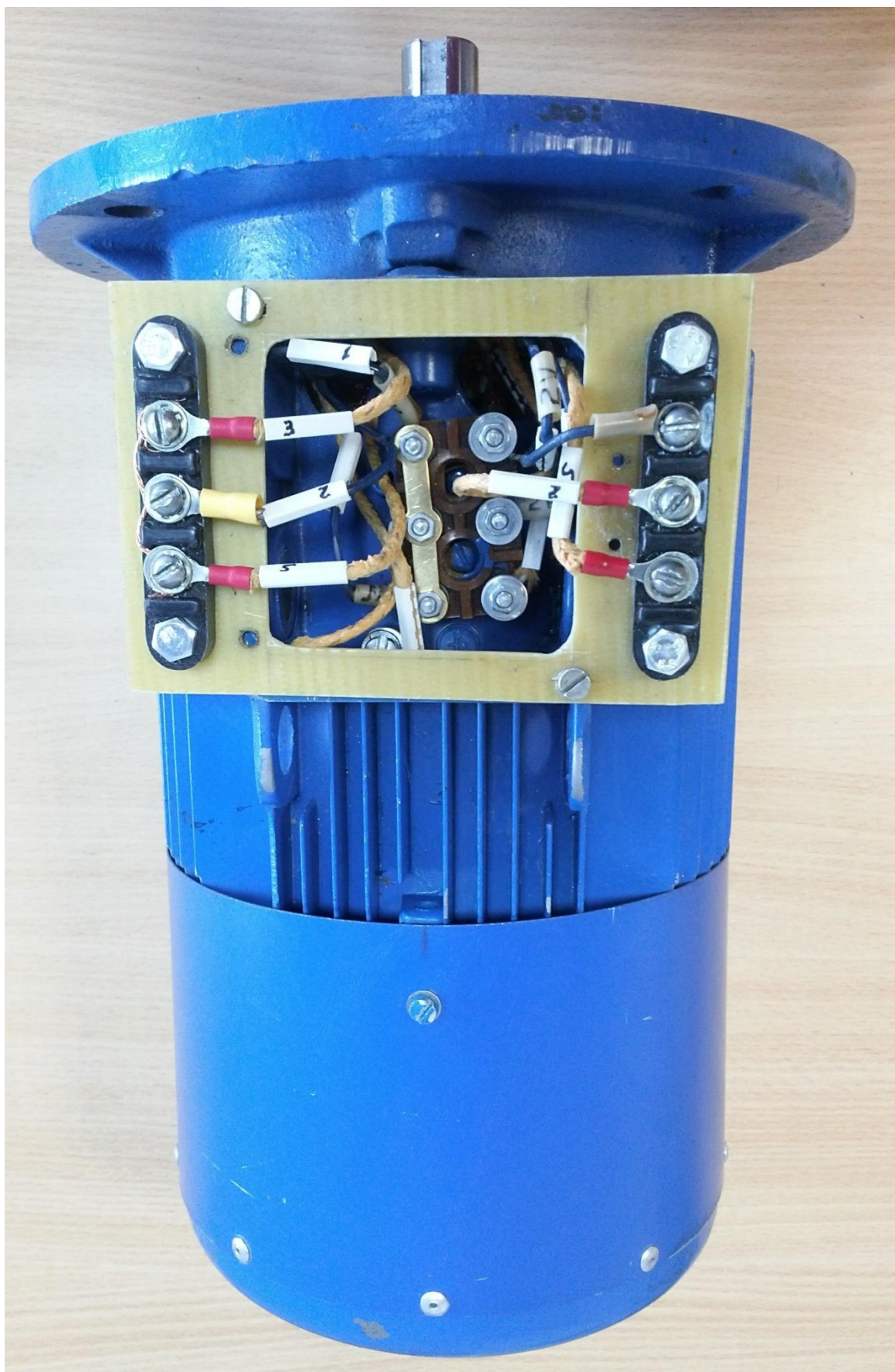
Рис.4.2. Вид экспериментального асинхронного двигателя с измененной клеммной колодкой
