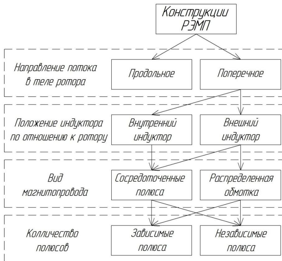
Рисунок 1.2. Схема конструкций РЭМП
