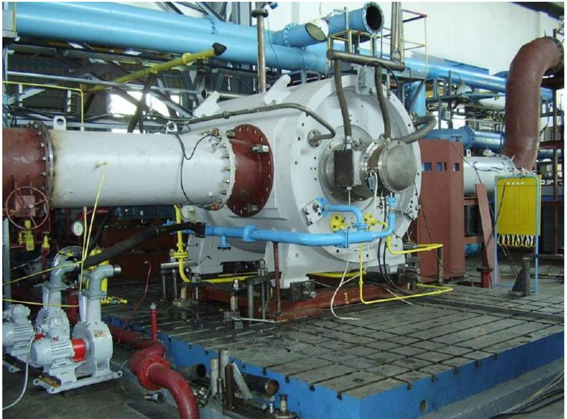
Рисунок 1.10. Общий вид компрессора 321 ГЦ2 с ЭМП
