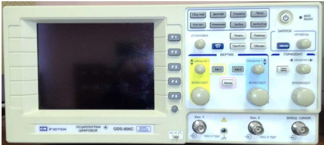
Рисунок 4.7 – Цифровой осциллограф GDS-806C
