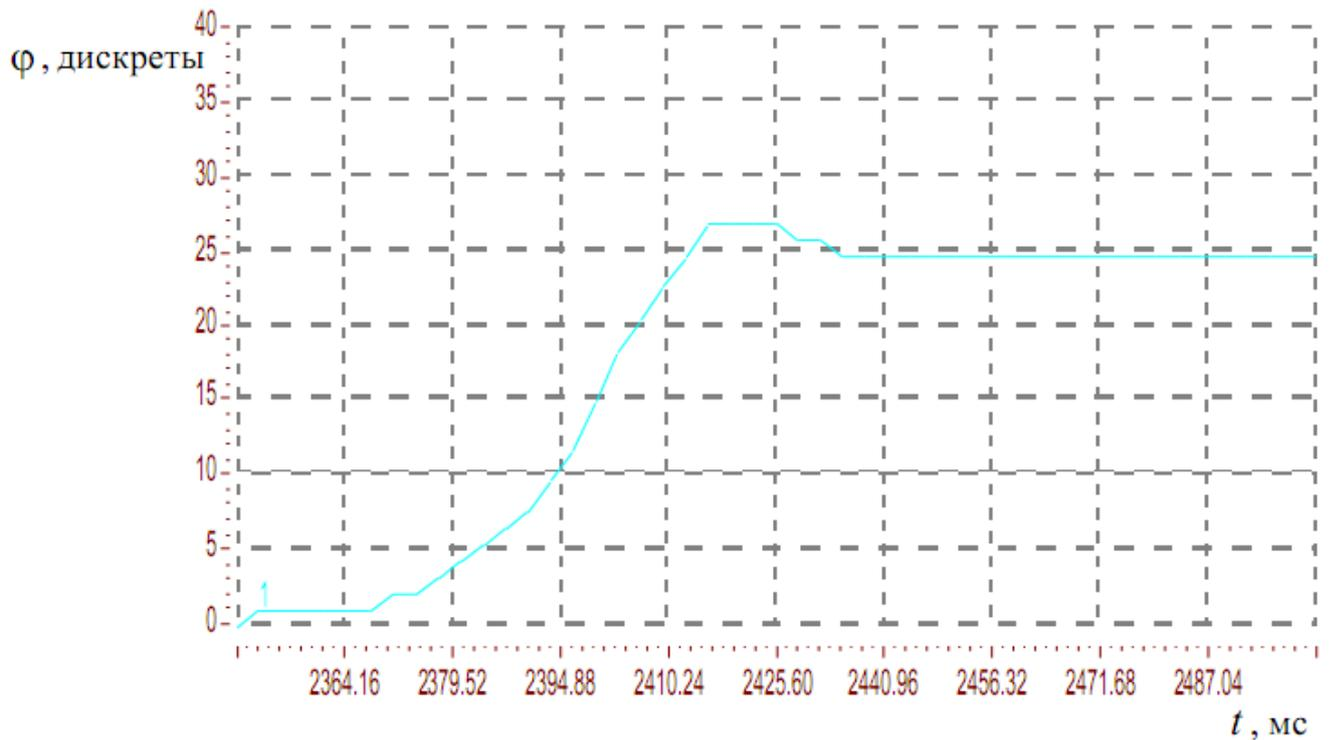
Рисунок 4.6 – Переходный процесс при расчетных параметрах регуляторов с дополнительной массой 30 кг
