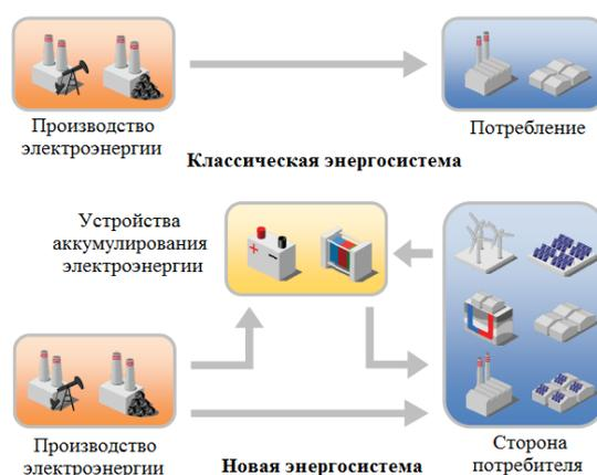
Рисунок 1.5 - Роль систем аккумулирования в энергосетях
