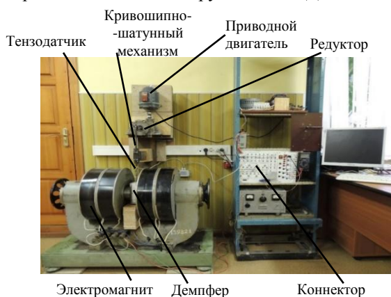
Рис. 15. Стенд для испытания ЭМЖД
