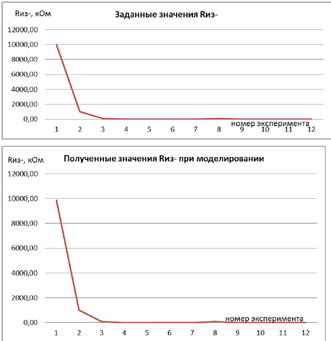
Рисунок 4.5- Диаграммы сопротивлений изоляции между «+» и корпусом.
