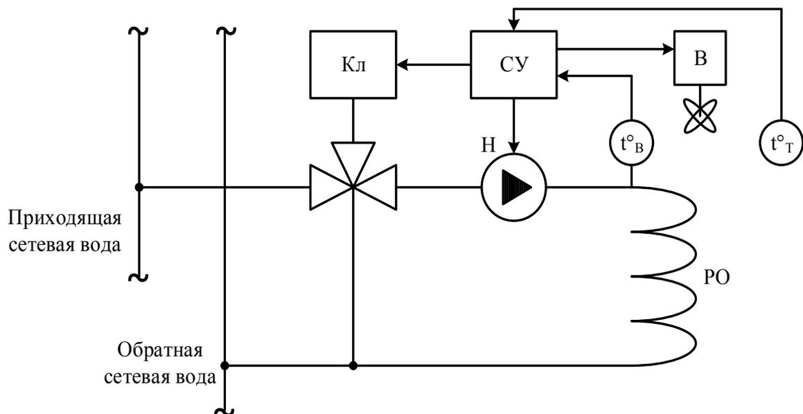
Рисунок 4 – Функциональная схема электротехнического комплекса управления температурой теплицы
