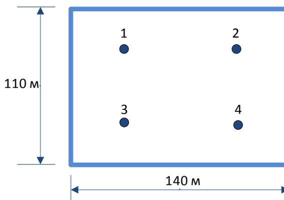
Рисунок 7 – Схема расположения датчиков в теплице
