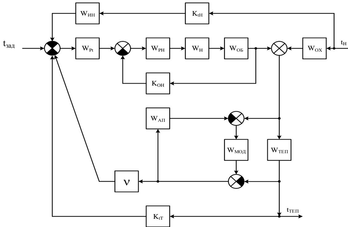
Рисунок 9 – Структурная схема системы управления электротехническим комплексом
