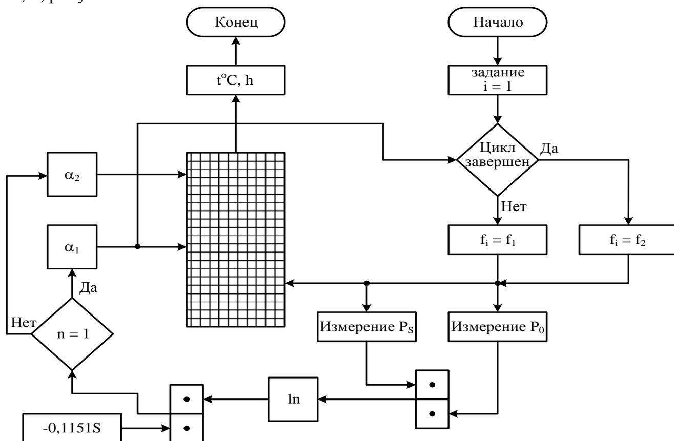
Рисунок 8 – Алгоритм вычисления  $t^{\circ}\text{C}$ ,  $h$
