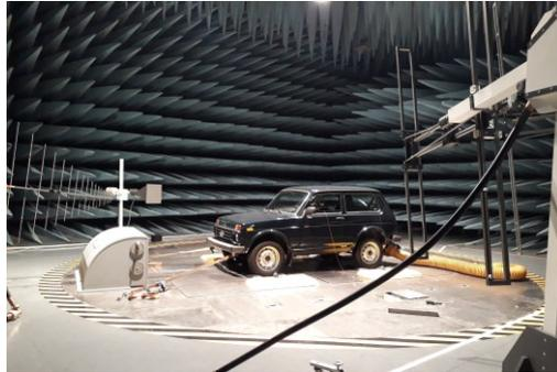
Рисунок 5 – Безэховая камера для испытаний автомобилей
