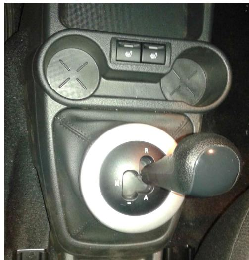
Рисунок 4.26 – Общий вид автоматизированной коробкой передач
