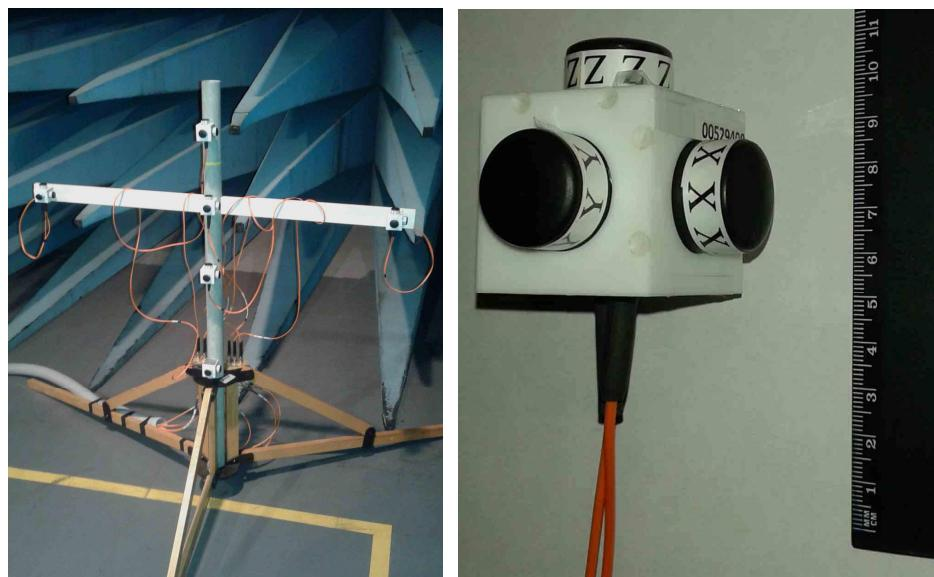
Рисунок 4.4 – Широкополосные изотропные датчики Е- поля RadiSense
