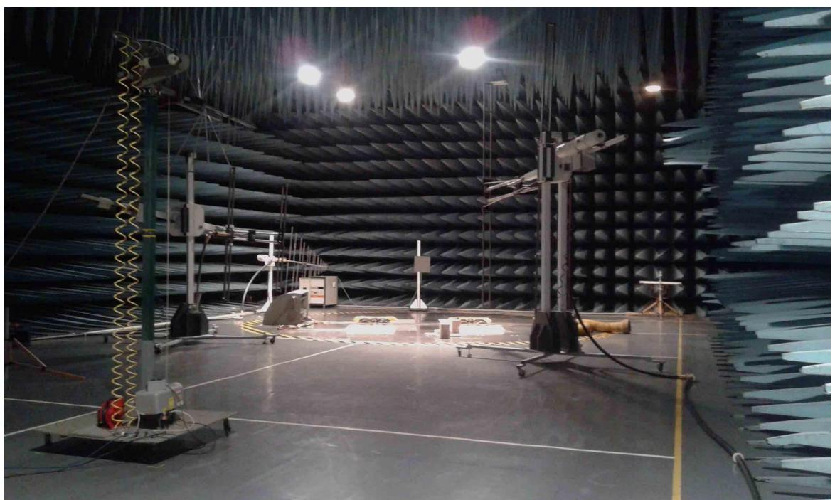
Рисунок 4.1 – Безэховая камера СВЧ комплекса ЭМС Волжского
