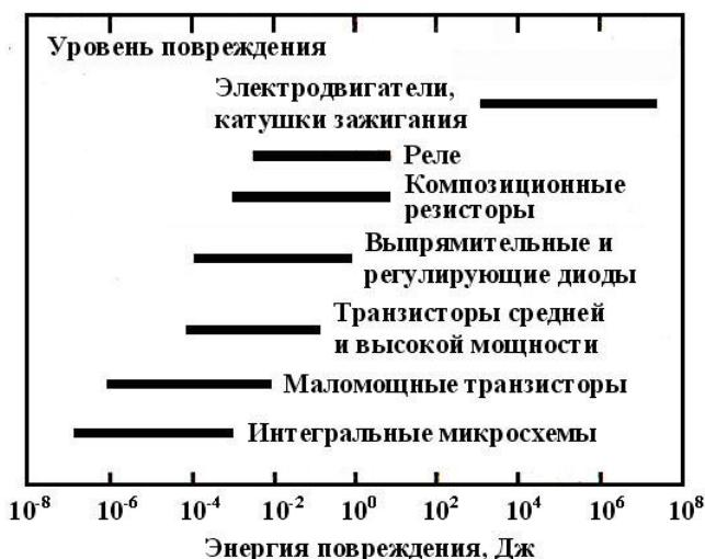
Рисунок 1.18 – Энергия повреждения элементов электротехнических систем АТС
