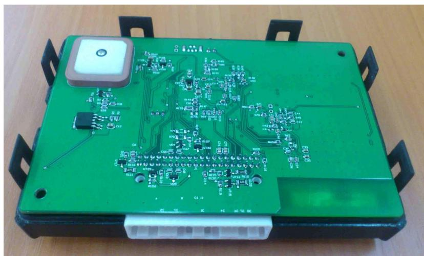
Рисунок 2.14 – Блок системы «Эра ГЛОНАСС» автомобиля LADA Vesta
