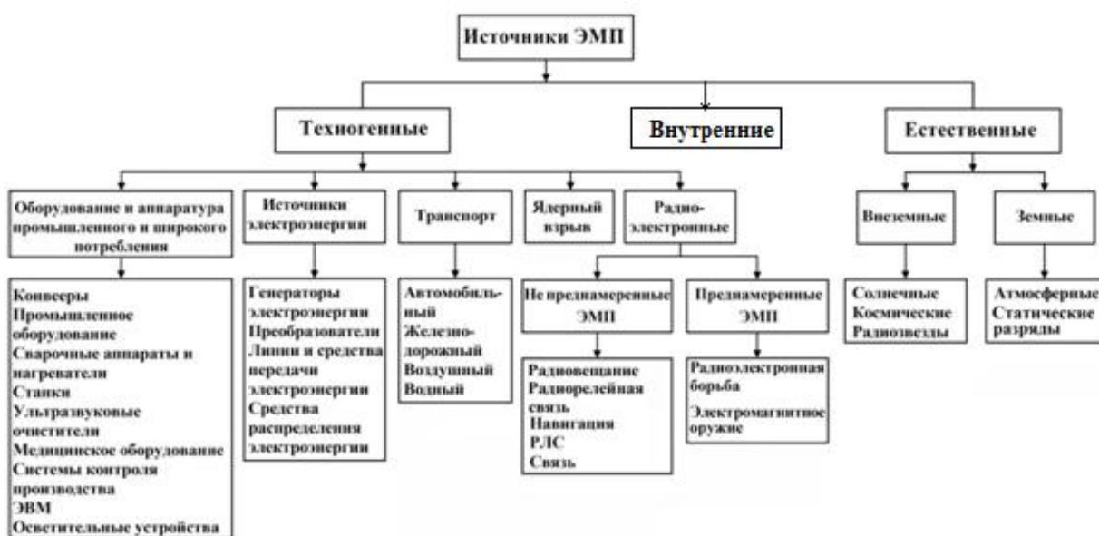
Рисунок 1.5 – Источники электромагнитных помех, формирующие внешнюю электромагнитную обстановку
