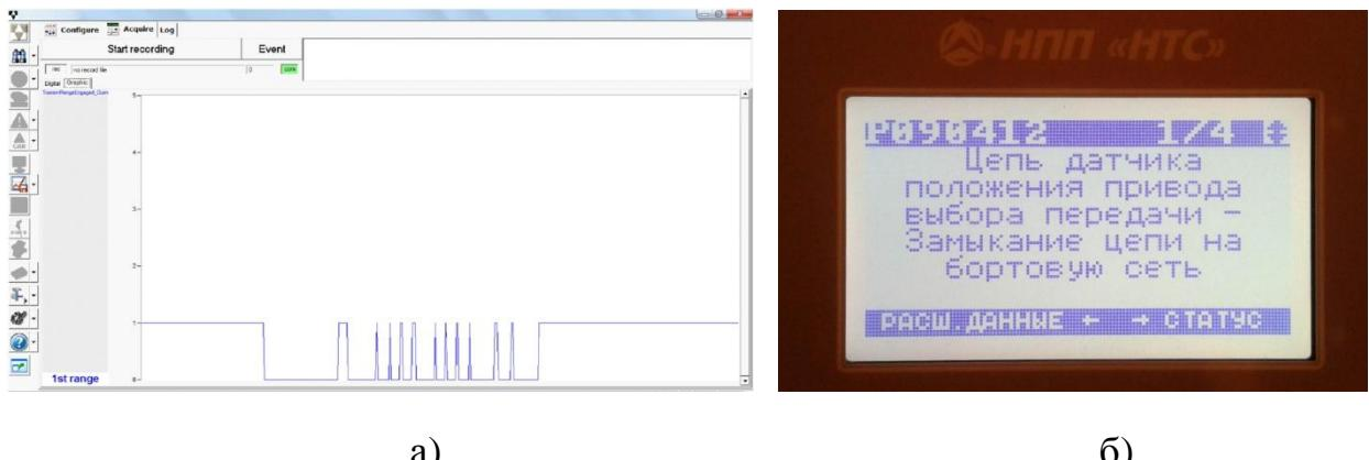
Рисунок 4.27 – Нарушение работоспособности электронной системы управления автоматизированной коробкой передач: а) самопроизвольное переключение с первой на нейтральную передачу; б) ложная диагностика ошибки
