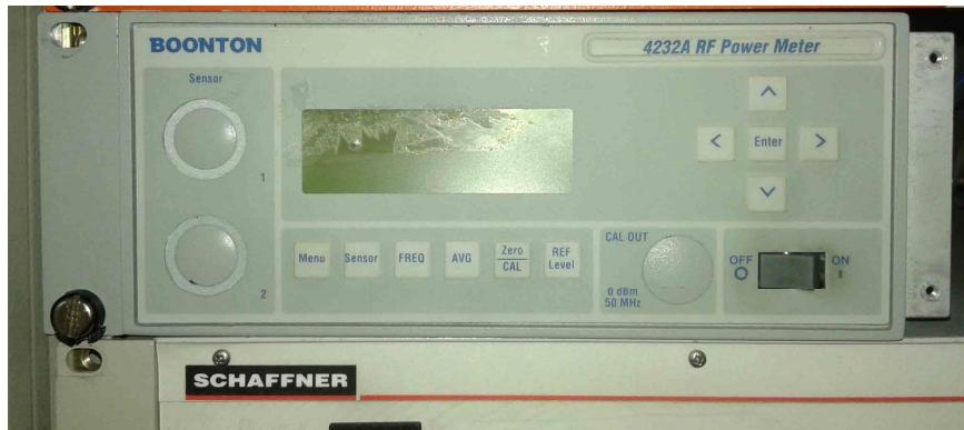
Рисунок 4.5 – Ваттметр поглощаемой мощности BOONTON 4232 A
