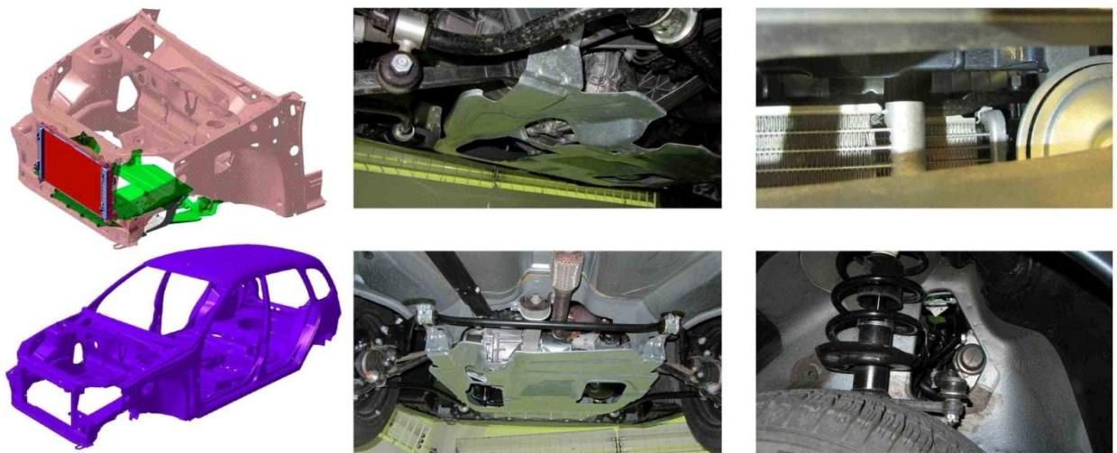
Рисунок 3.9 – Щели и отверстия кузова как места проникновения излучения во внутреннее пространство автотранспортного средства
