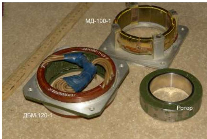
Рисунок 4.4 – Сравнительные габариты двигателя ДБМ 120-1 и МД-100-1
