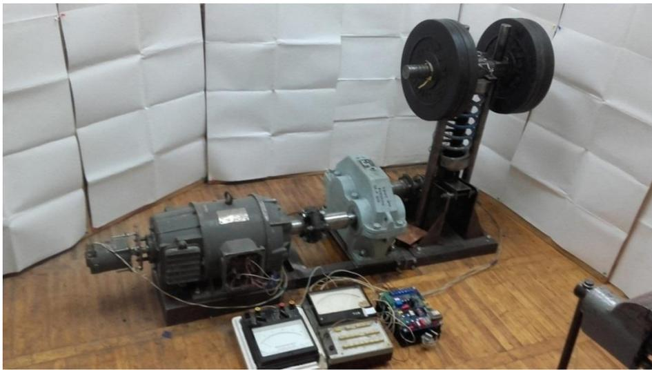
Рис. 43 – Экспериментальная установка для исследования активной системы виброзащиты автомобиля
