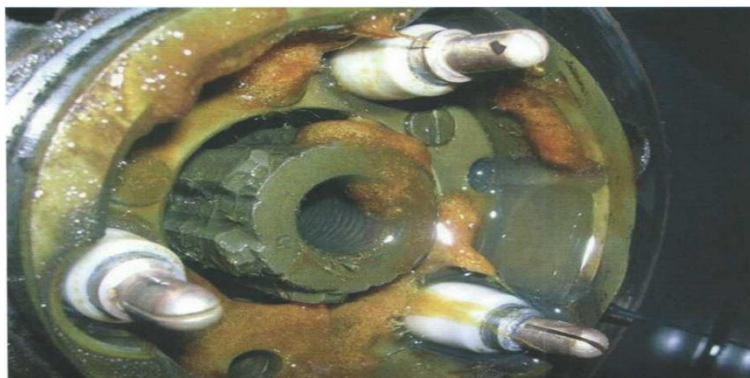
Рис. А.15.3. Перегрев статора ПЭД и плавление лаковой пропитки.
