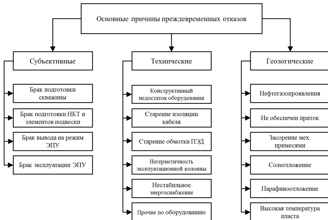
Рис. 2.11. Основные причины преждевременных отказов в работе ЭКПЭД и ПЭД.
