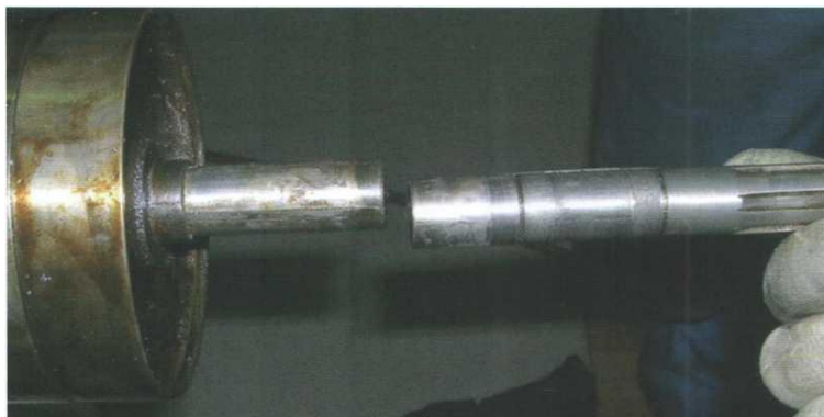
Рис. А.8. Слом вала секции ЭЦН.
