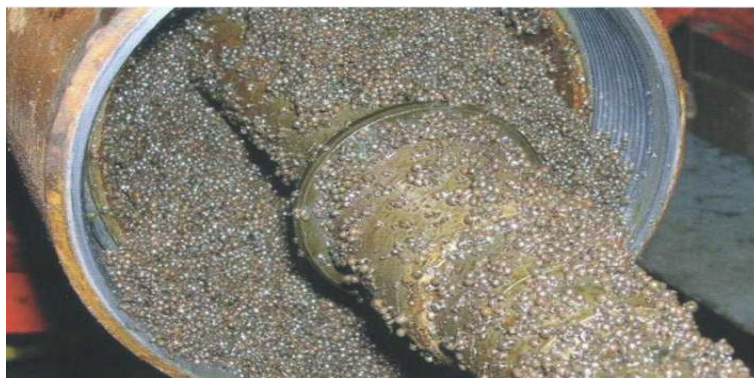
Рис. А.9. Внутренняя полость ЭЦН забита проппантом.
