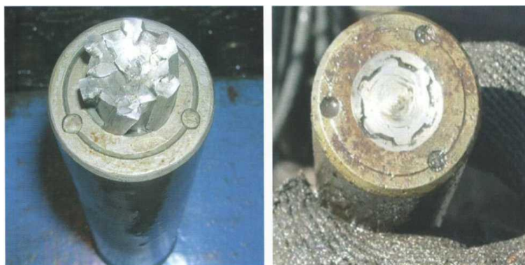
Рис. А.7. Слом вала в шлицевой части.
