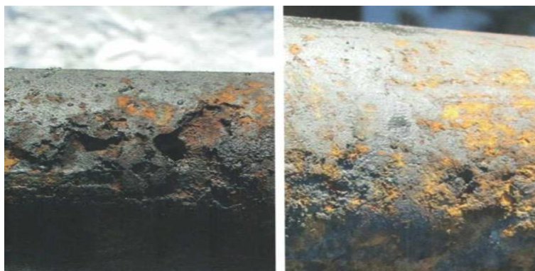
Рис. А.2. Коррозия по телу НКТ.
