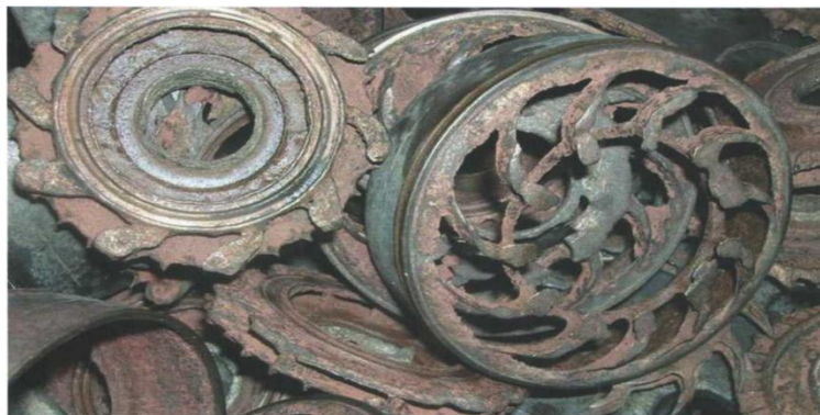
Рис. А.6. Рабочие колеса и направляющие аппараты ВНН 159.
