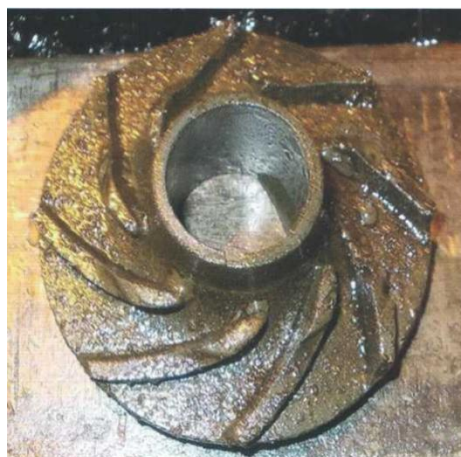
Рис. А.5. Износ рабочих органов ЭЦН.
