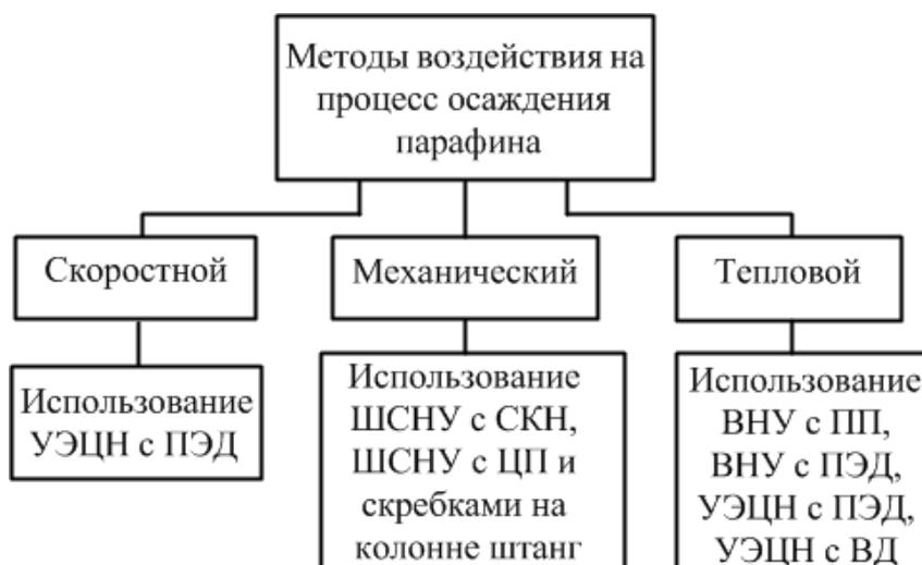
Рисунок 1.13 – Методы воздействия на процесс осаждения парафина
