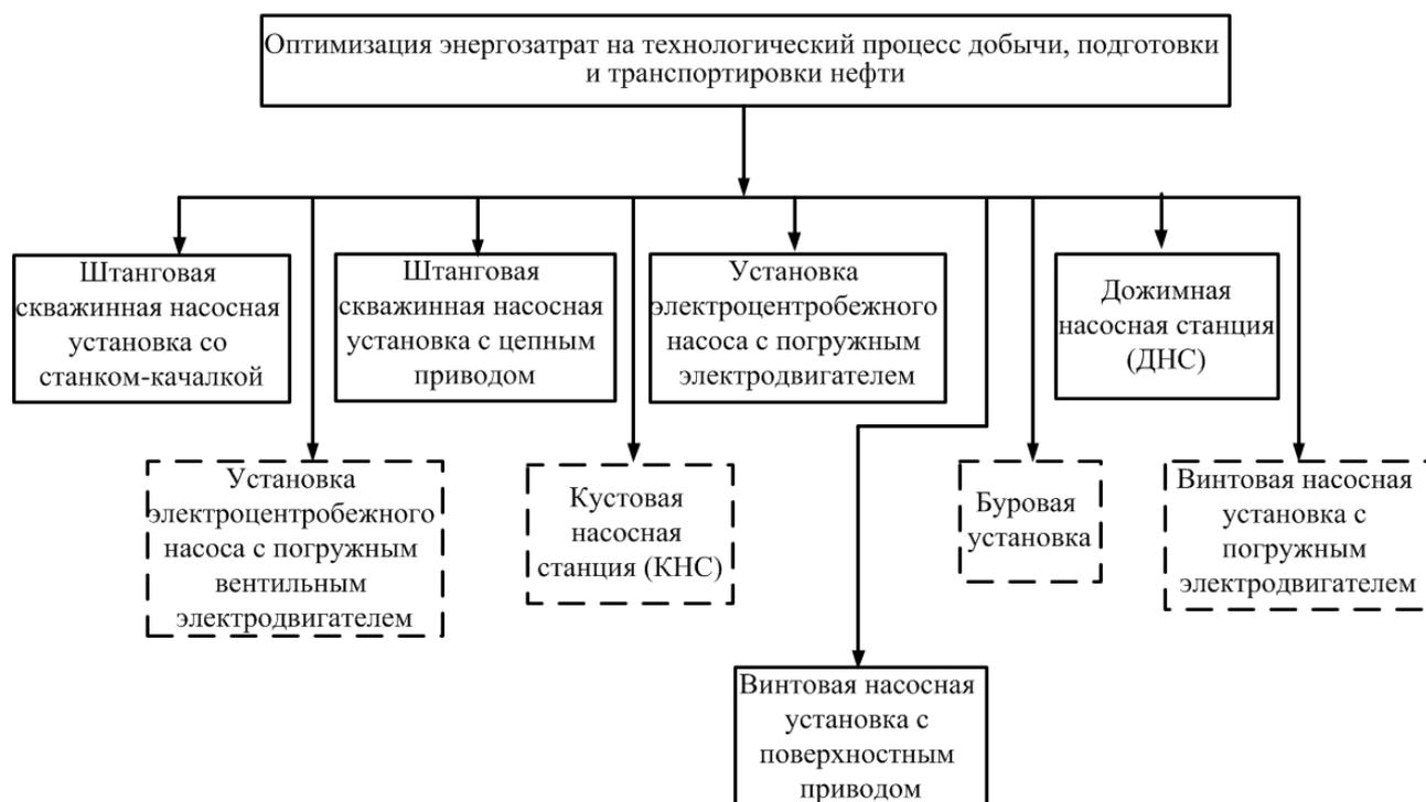
Рисунок 1.7 – Технологический процесс добычи нефти
