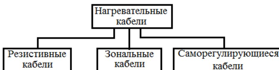
Рисунок 1.2 – Типы нагревательных кабелей
