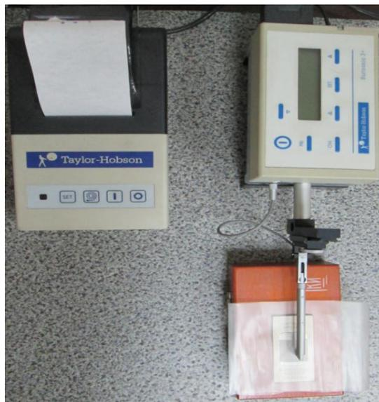
Рисунок 4.19. Прибор для измерений параметров шероховатости детали «Taylor – Hobson Surtronic 3+»
