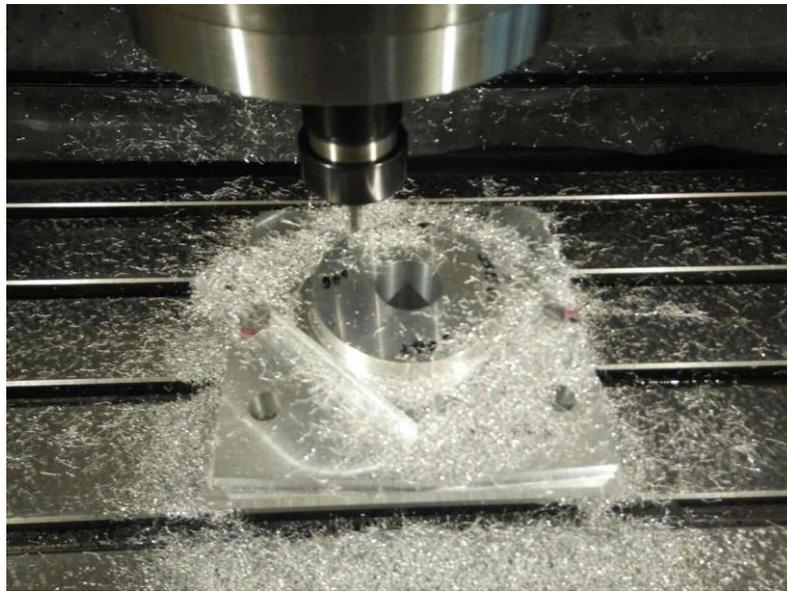
Рисунок 4.20. Процесс обработки эталонной окружности на станке модели 2440СФ4
