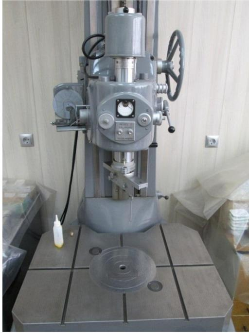
Рисунок 4.18. Прибор для измерений отклонений от геометрической формы детали «TALYROND» Model №2
