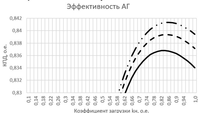
Рисунок 9 — Рабочая характеристика асинхронного генератора
