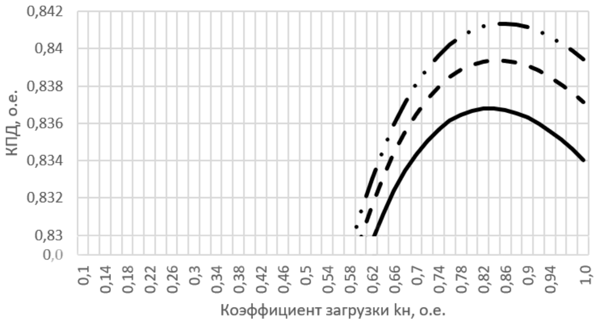
Рисунок 4.7. Зависимость КПД от коэффициента загруженности
