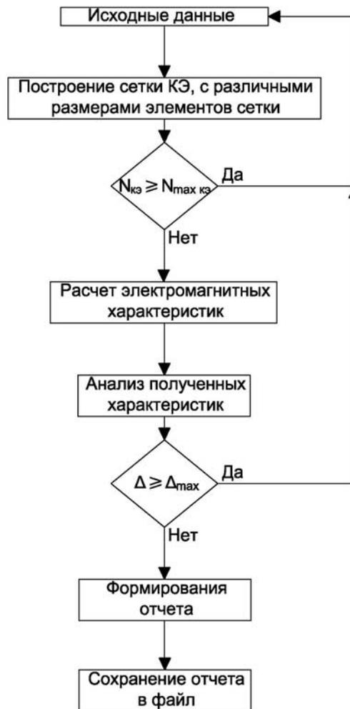
Рис. 2.1. Алгоритм программы расчета электромагнитной задачи.
