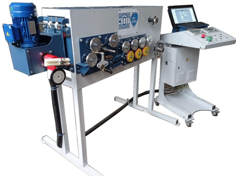
Рисунок 4.3 – Станок для намотки ВТСП катушек
