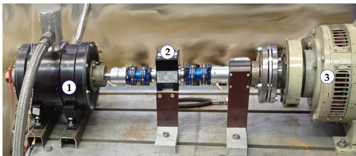
Рисунок 6.18 – Стенд для испытаний электрических машин:
