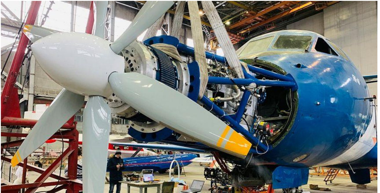
Рисунок 1.3 – ВТСП двигатель компании «СуперОкс» в процессе установки на летающую лабораторию Як-40ЛЛ
