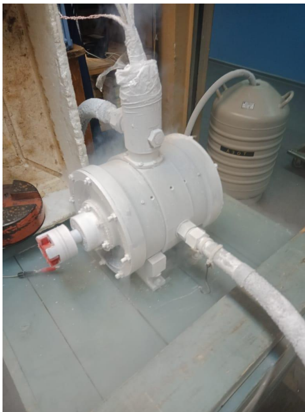
Рисунок 6.12 - Внешний вид сверхпроводниковой электрической машины с кольцевой обмоткой якоря
