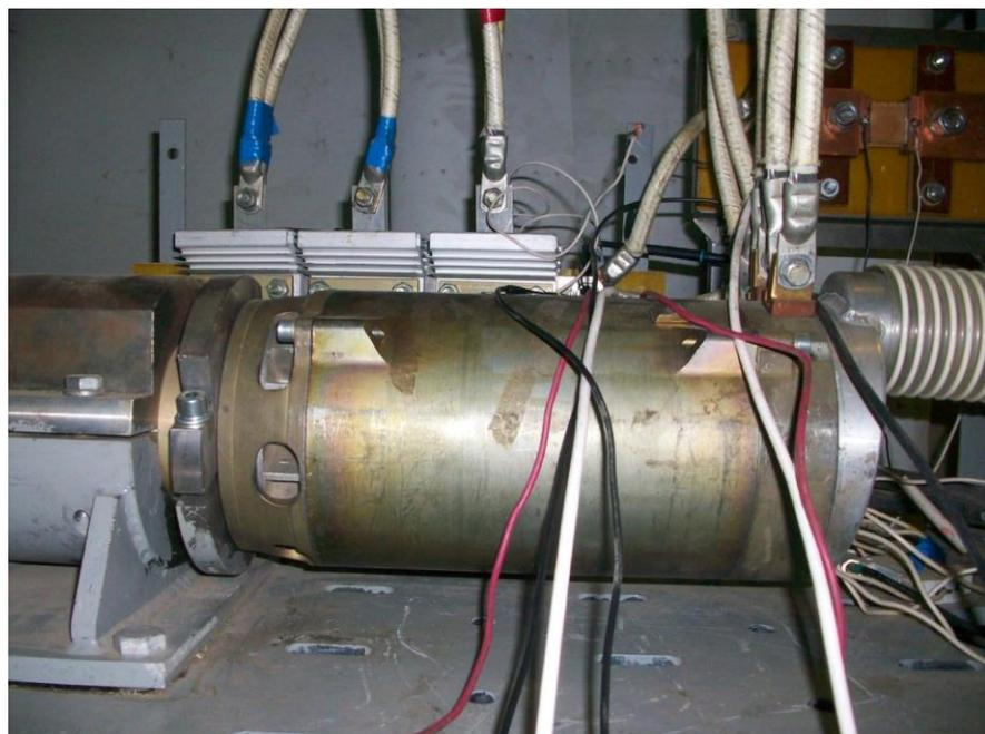
Рис.8.1. Генератор с интегрированным возбудителем
