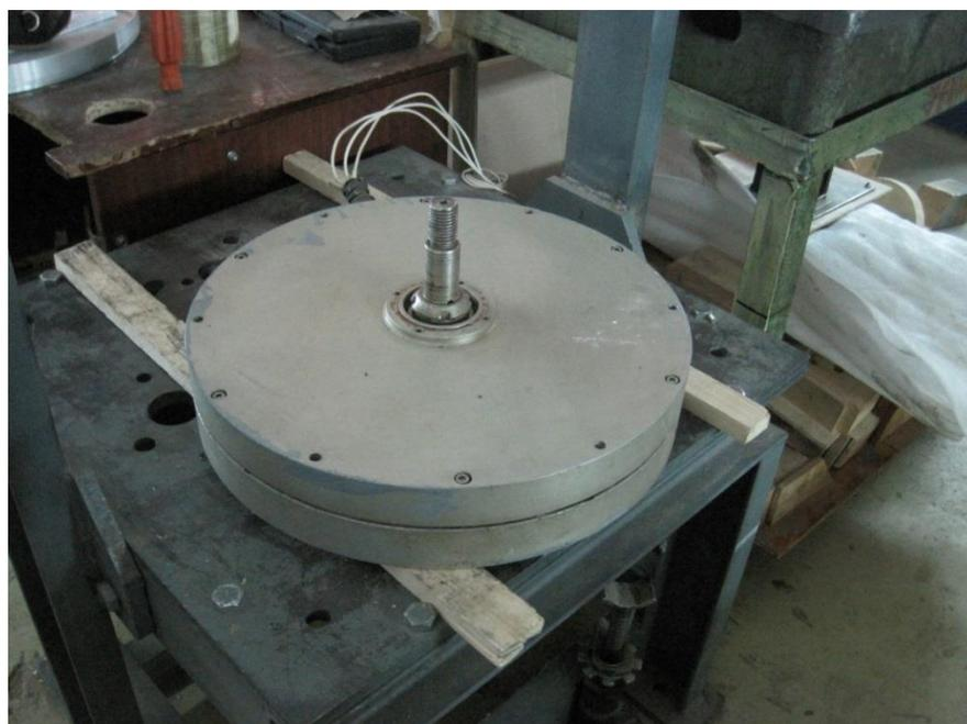
Рисунок 8.23 - Генератор с магнитоэлектрическим возбуждением
