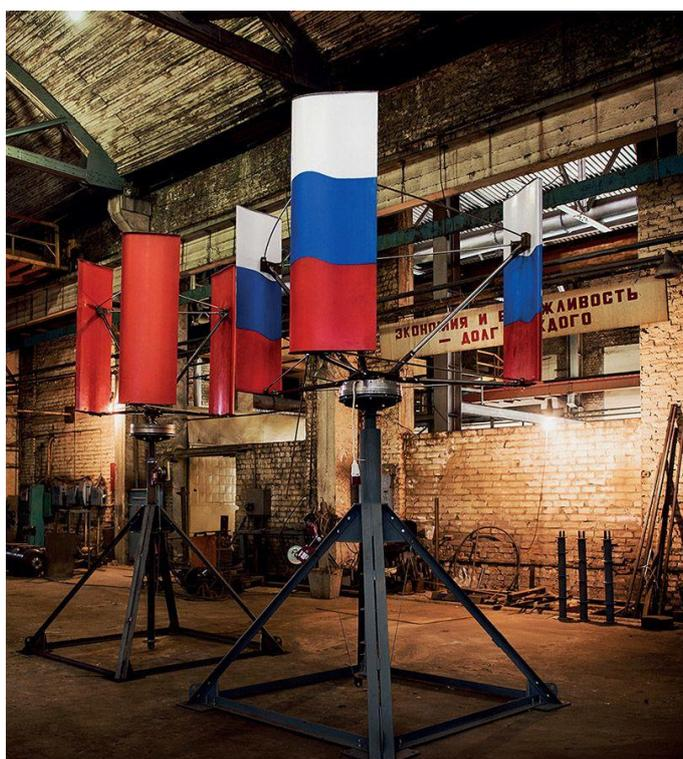
Рисунок 8.19 – Ветроустановка мощностью 2 кВт с ротором Дарье
