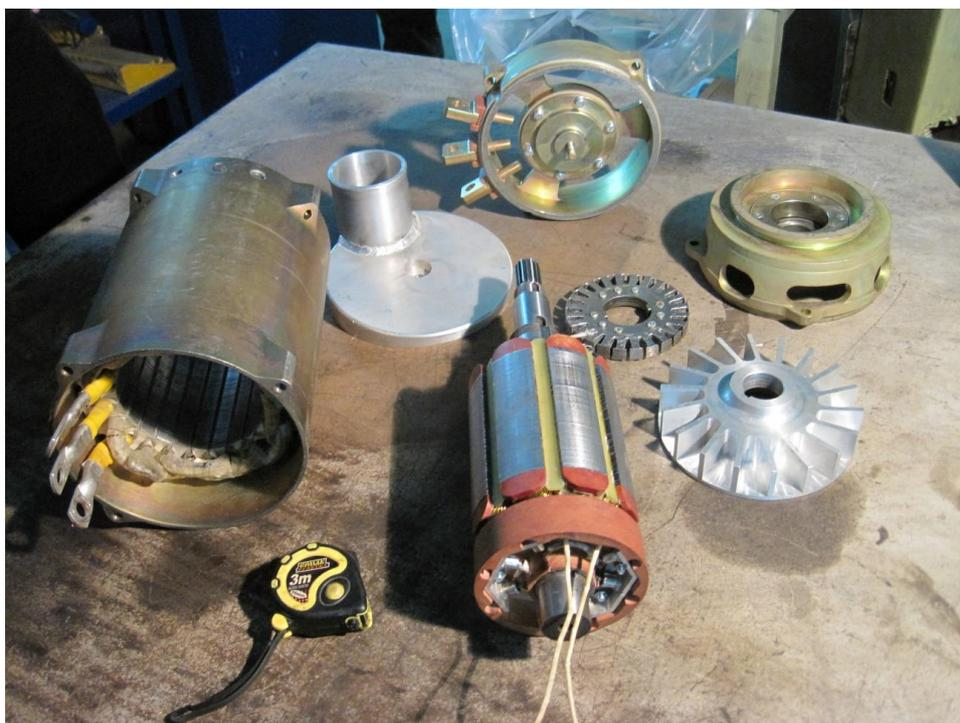
Рис.8.2. Статор в сборе, ротор в сборе, щит, крыльчатка
