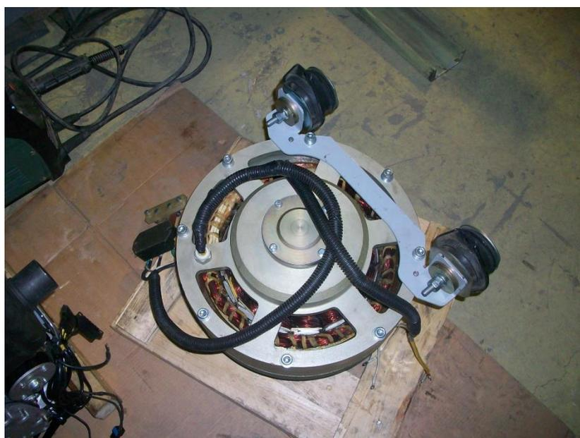
Рисунок 8.33 - Двухкаскадный генератор
