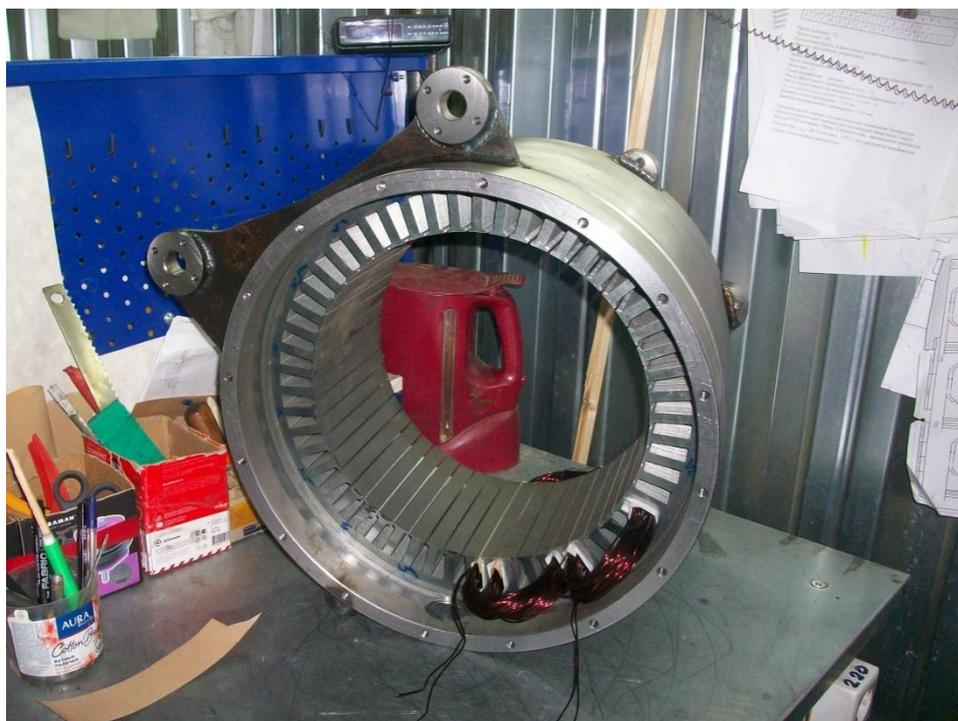
Рисунок Б.3 - Статор стартера 250 кВт
