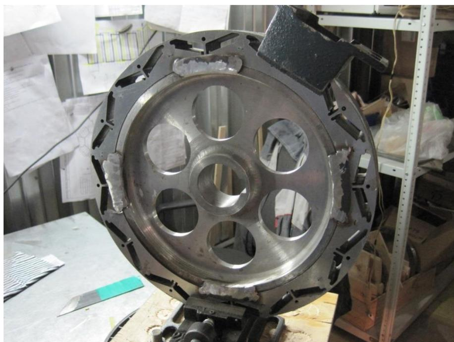
Рисунок 8.25 - Сердечник ротора (тип 1)
