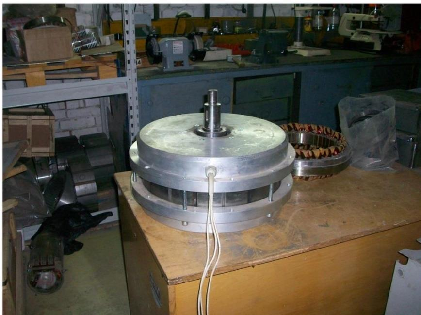
Рисунок 8.22 - Генератор с магнитоэлектрическим возбуждением
